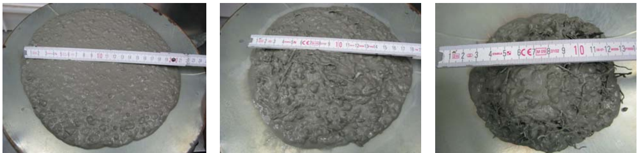
Abbildung 27: Ausbreitmaß der Betone B0 (225 mm, links), B8 (185 mm, Mitte) und B3 (129 mm, rechts)
