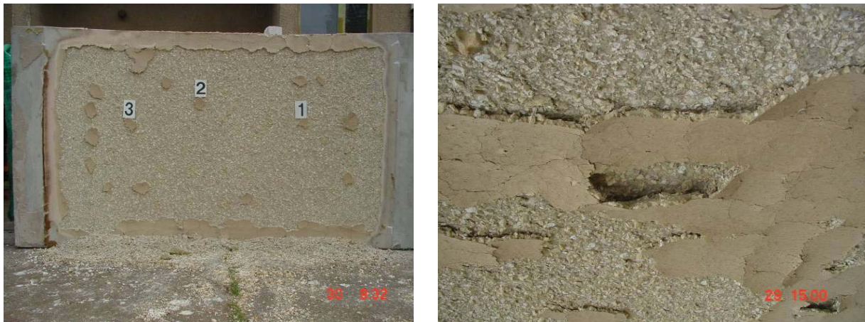
Abbildung 4: Tübbinge mit 2 kg/m 3 Polypropylenfaserzusatz nach dem Brandversuch (links) und Detailaufnahme (rechts) /Dehn06/
