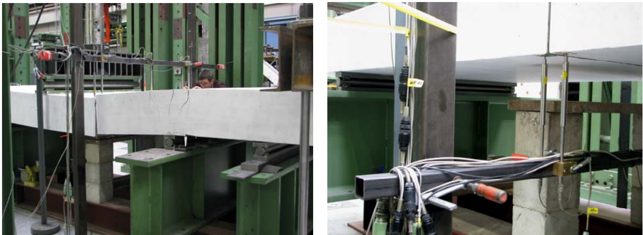
Abbildung 16: Versuchsaufbau während des Versuchs (links) und induktive Wegaufnehmer zur Erfassung der Bauteilverformung (rechts)
