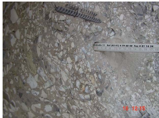
Abbildung 3: Tübbinge ohne Polypropylenfaserzusatz nach dem Brandversuch (links) und Detailaufnahme (rechts) /Dehn06/
