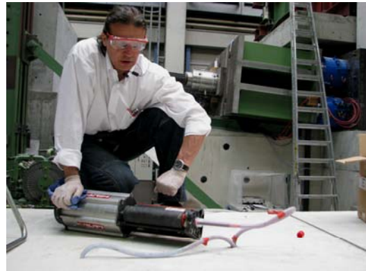
Abbildung 12: Herstellung des Versuchsaufbaus zur Untersuchung des Tragverhaltens der Kopplung: (a) Herstellung der Bewehrungskörbe, (b) Einschweißen des Stahlbauteils zur Aufnahme des Stahlbolzens, (c) fertiggestellte Bewehrungskörbe mit Verpressschläuchen, (d) Betonage der Bauteile, (e) Aufbau des Versuchsstands, (f) Verpressen des Stahlbolzens
