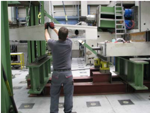
Abbildung 12: Herstellung des Versuchsaufbaus zur Untersuchung des Tragverhaltens der Kopplung: (a) Herstellung der Bewehrungskörbe, (b) Einschweißen des Stahlbauteils zur Aufnahme des Stahlbolzens, (c) fertiggestellte Bewehrungskörbe mit Verpressschläuchen, (d) Betonage der Bauteile, (e) Aufbau des Versuchsstands, (f) Verpressen des Stahlbolzens
