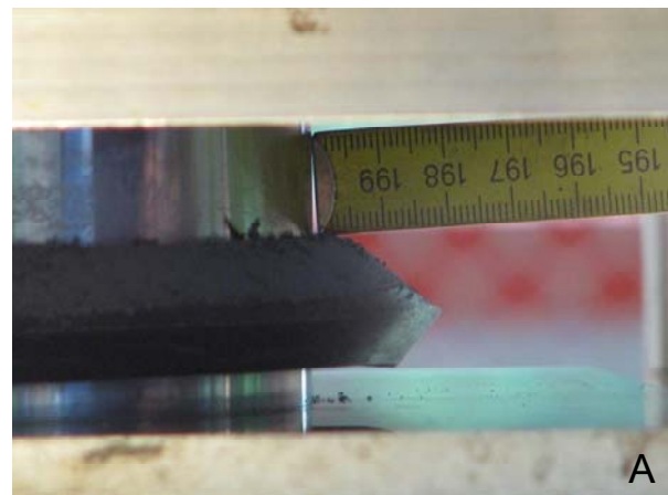
Abbildung 11: Verpresste Stahlplatten vor Versuchsbeginn (oben) und während des Versuchs (unten links) mit Detail (unten rechts)
