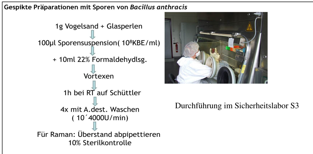
Abbildung 7: Darstellung der Herstellung von gespiktem Probenmaterial mit Sporen von Bacillus anthracis am Beispiel von Sand
