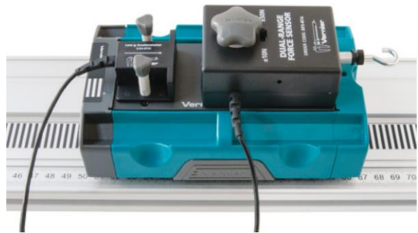
Figur 11: Experimentierwagen «Dual-Range-Force-Sensor und low-g-Accelerometer»
