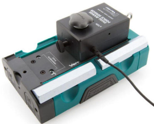
Figur 10: Experimentierwagen mit zwei Massentücken und «Dual-Range-Force-Sensor»
