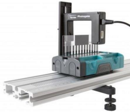
Figur 20: kopfseitige Befestigung einer Lichtschranke (Wagen mit Streifenmuster, Cart Picket Fence PF-CART)
