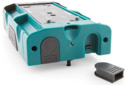
Figur 9: Experimentierwagen mit Stos-Einschüben, links: montiert, rechts: entfernt
