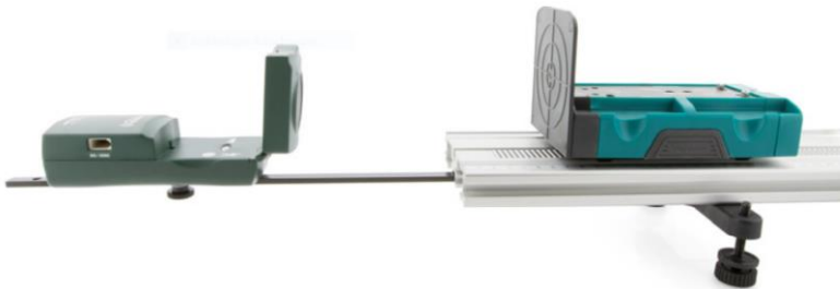
Figur 15: Ultraschall-Distanzsensor auf Halterung montiert (links). Experimentierwagen mit Reflektorscheibe (rechts)
