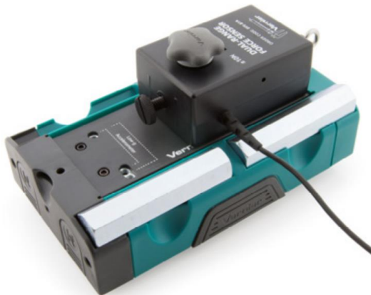
Figur 43: Experimentierwagen DTS-CART-MEC mit Kraftsensor DFS-BTA
