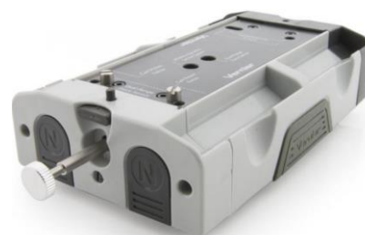
Figur 5: Experimentierwagen DTS-Cart-P mit Feder-Stosskolben
