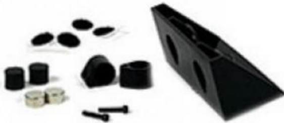
Figur 12: Endanschlag (rechts) mit Kupplungs- bzw. Stossdämpfermaterial (Magnete)
