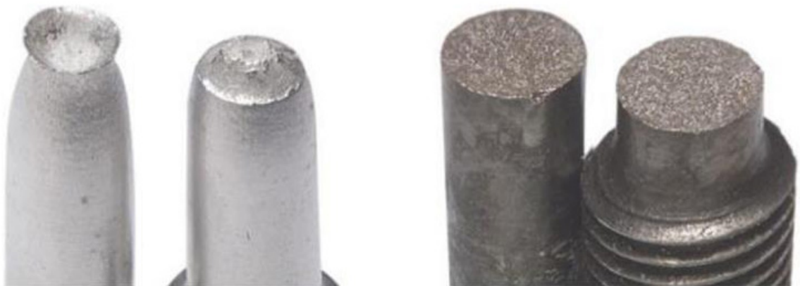
Abb. 8.3 Bruchbilder nach einem Zugversuch. Links: duktiles Material, rechts: sprödes Material
