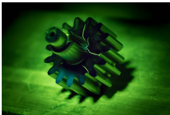
Abb. 8.24 Sichtbarmachung der Risse in einem Zahnrad
