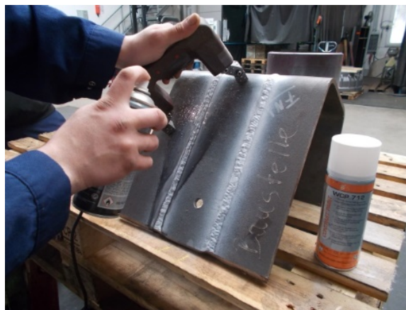
Abb. 8.23 Untersuchung einer Schweißnaht auf Risse mit Hilfe der Magnetpulverprüfung
