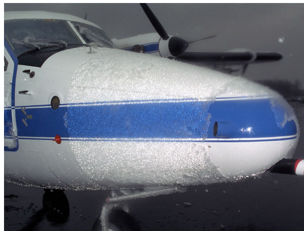
Abbildung 2.1.: Vereisung am Flugzeugrumpf der NASA 607, einer modifizierten DHC-6 zur Erforschung von Vereisung [1]
