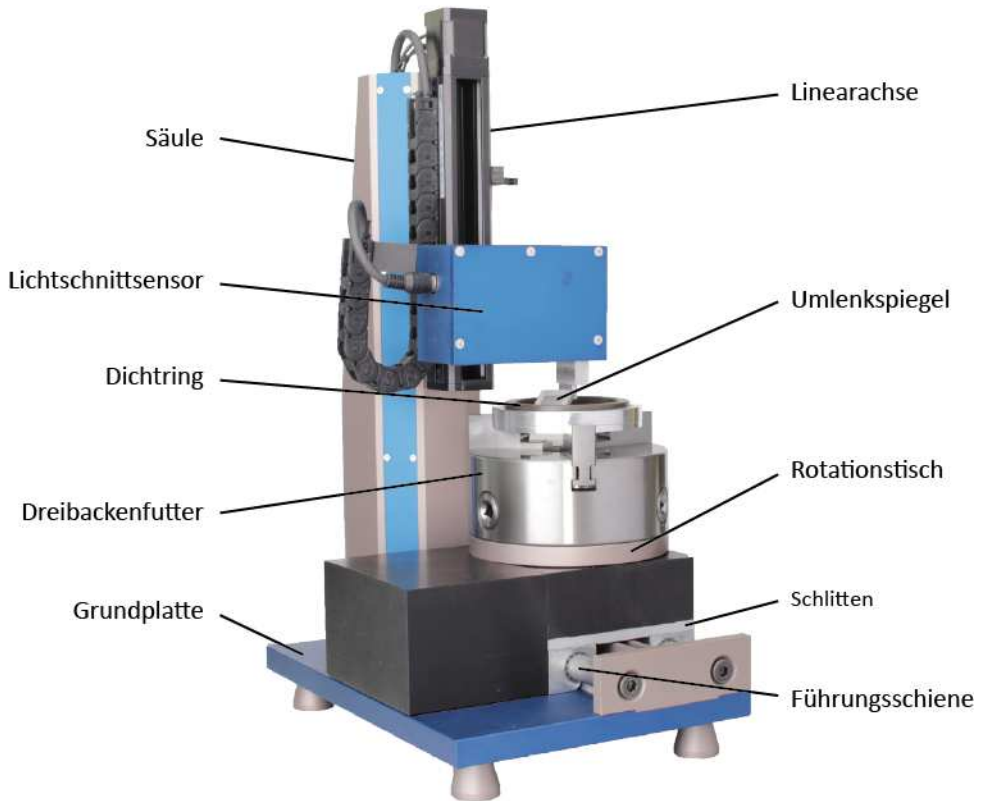
Bild 10: Aufbau IMA-Sealscanner
