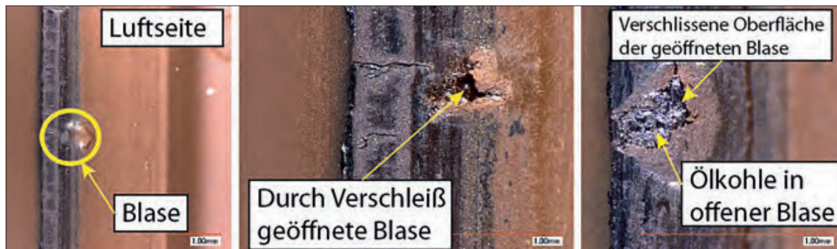
Bild 15: Beispiel von Blasenbildung unter der Dichtkante im Feldeinsatz (Bild: Universität Stuttgart, Institut für Maschinenelemente (IMA))
