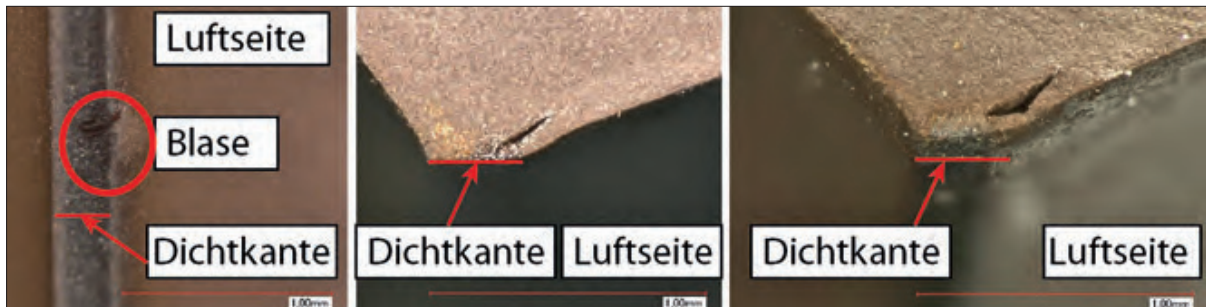
Bild 10: Blasen im Querschnitt (links und Mitte Blase 1, rechts Blase 2) (Bild: Universität Stuttgart, Institut für Maschinenelemente (IMA))
