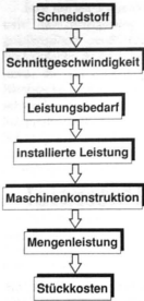
Bild 3. Funktionskette bei der Schneidstoffentwicklung
