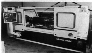
Bild 11. Feindrehmaschine mit hydrostatischer Spindellagerung, Bett aus Granit (Hemburg, Haarlem)
