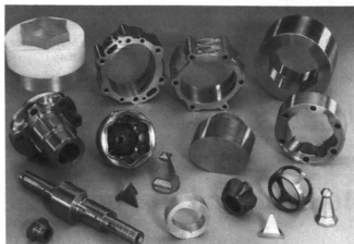
Bild 14. Beispiele komplett bearbeiteter Unrunddrehteile (Heckler & Koch, Schramberg)
