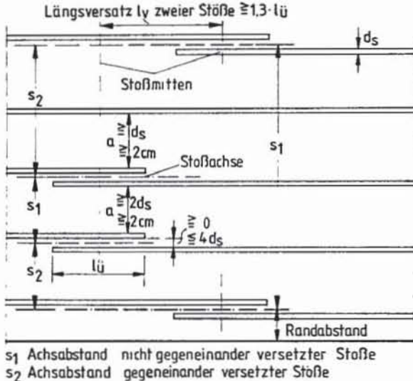
Bild 18: Längsversatz und Querabstand der Bewehrungsstäbe im Stoßbereich
