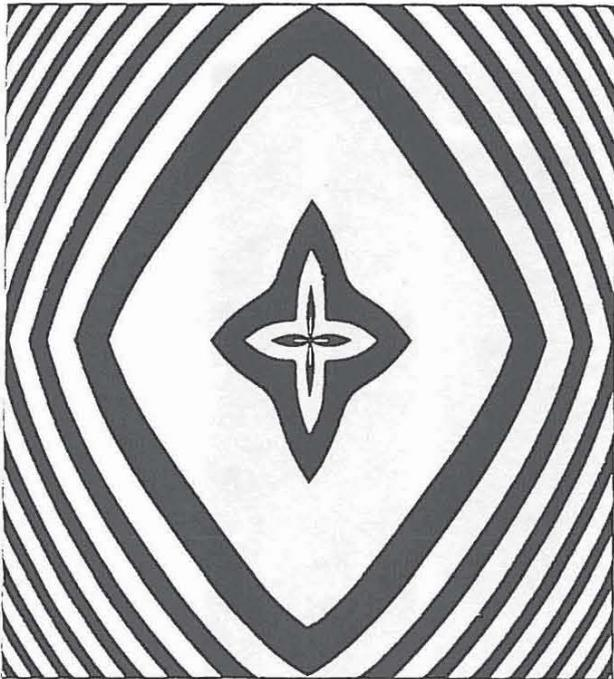
Bild 7: Phasenfeld zur Erzeugung einer Quadratfokuslinie
