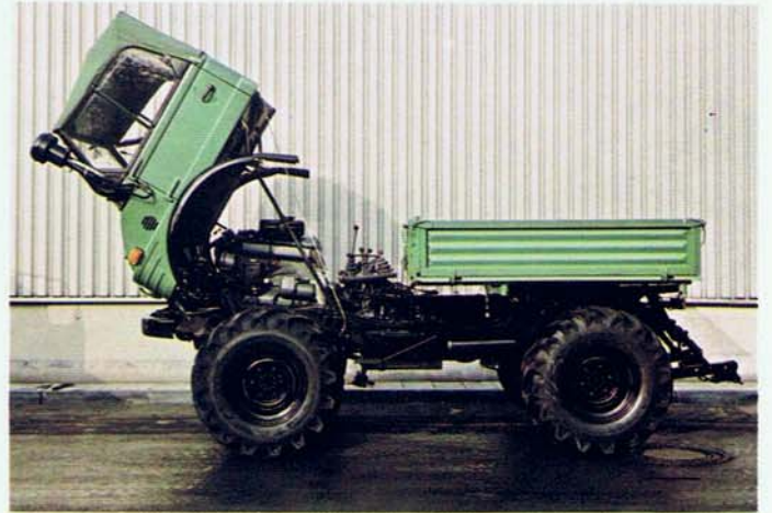
Das hochstellbare Fahrerhaus erleichtert die Wartung und verkürzt somit Werkstattzeiten.
