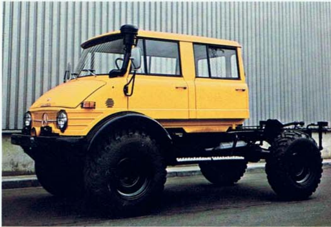
Doppelkabine. In Ganzstahlausführung für 5 Personen. Zusatzheizung und 2 Dachentlüftungsklappen.
