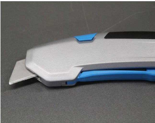
Abb. 5 Die Klinge des Sicherheitsmessers wird durch Hochziehen des Griffs herausgeschoben
