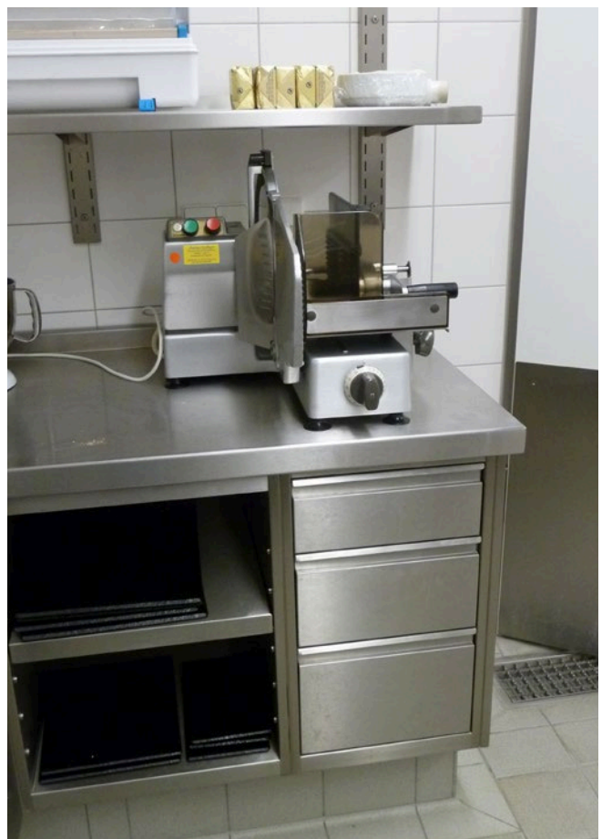
Abb. 8 Geeignete Aufstellung der Aufschnittschneidemaschine
