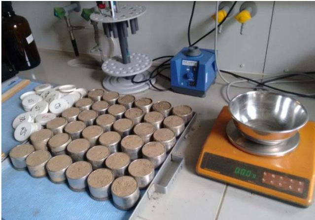
Abb.12: Verwiegung der Stechzylinder
