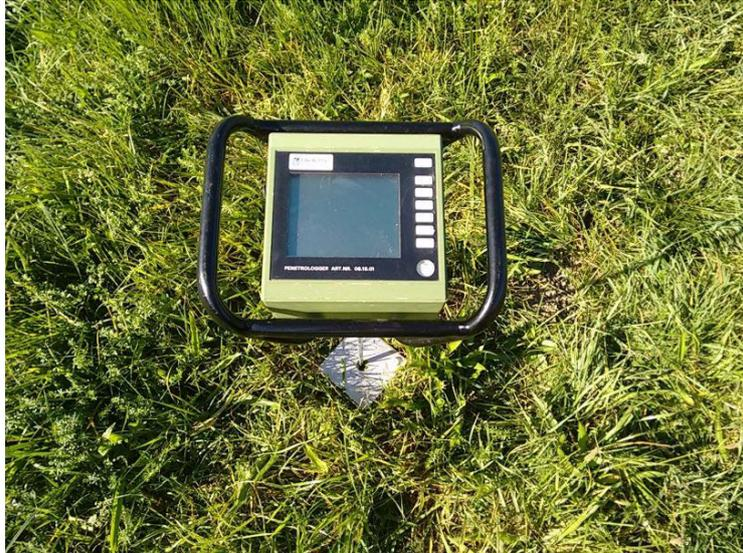
Abb.14: Messung des Eindringwiderstandes mittels Penetrologger
