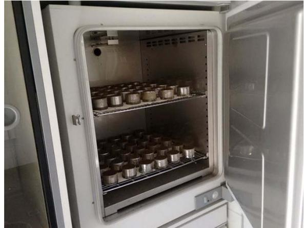
Abb.13: Trocknung der Bodenproben
