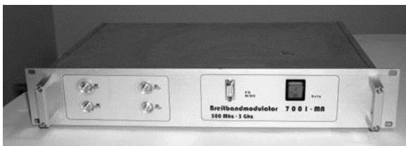
Abbildung 4-5 zeigt das entwickelte heterodyne Reflektometer.
