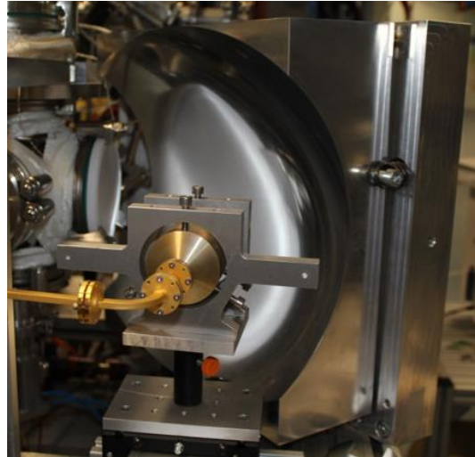
Abbildung 4-4 zeigt Antenne und Spiegel des Mikrowelleninterferometers zur Untersuchung der Mikrowellenentladung.
