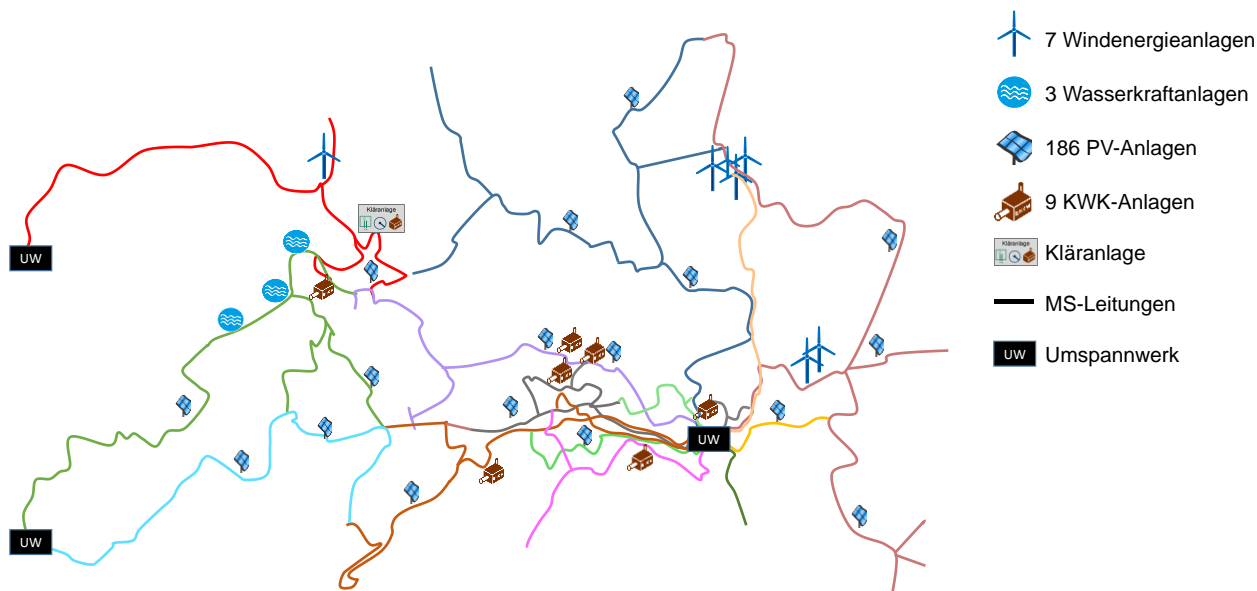
Bild B.3.8: Lageorientierte Darstellung des 10 kV Mittelspannungsnetzes
