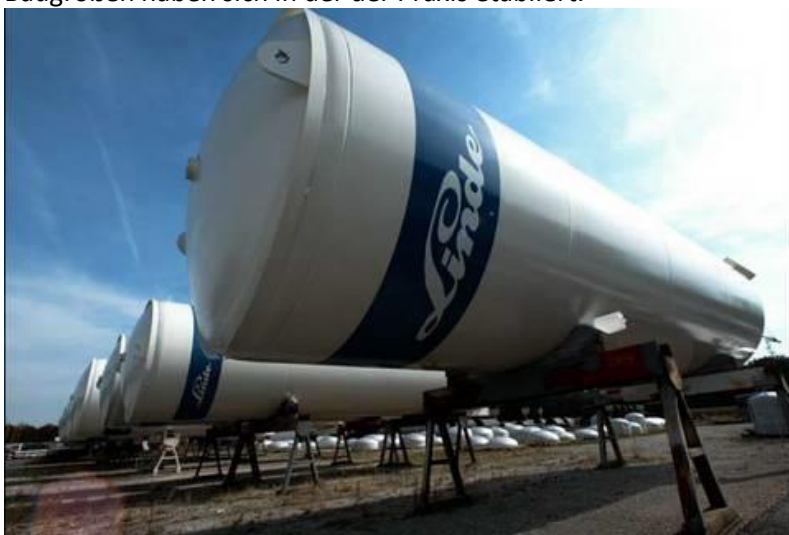
Bild B.3.16: Große ortsfeste Druckgasbehälter für Industriekunden, 50 bar (Foto: Linde AG)
