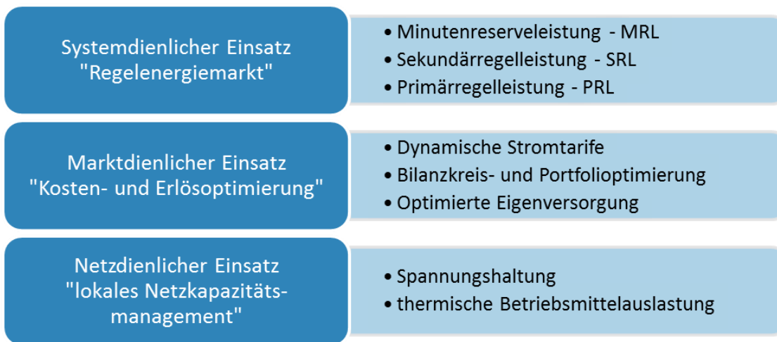
Bild B.1.3: Kategorien des Flexibilitätseinsatzes (in Anlehnung an (Gretzschel et al., 2016a; Schmitt et al., 2017))
