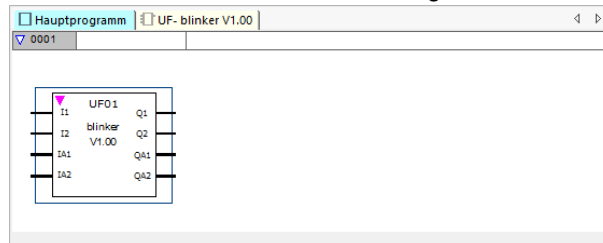
Abb. 277: Im Hauptprogramm verwendeter Anwenderbaustein UF Blinker1
