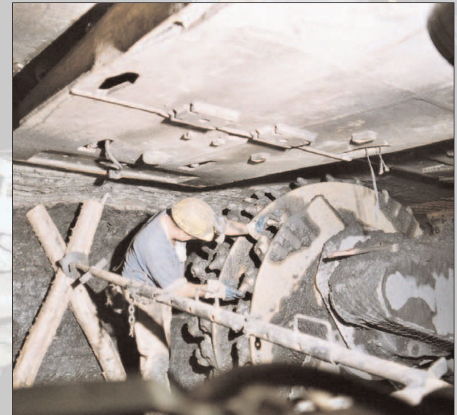
Bild 6: Sicherung durch Kohlenstoßspreize.
