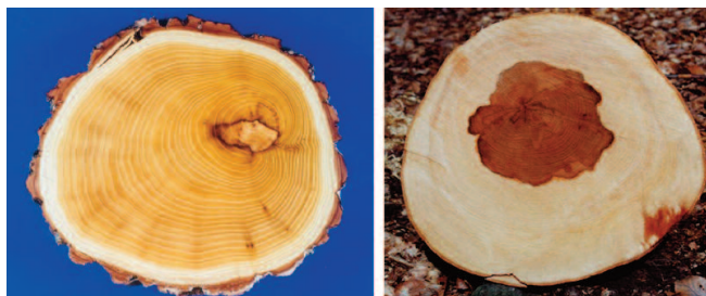
Abb. 2.13: Stammscheiben von Robinie, als Beispiel für eine obligatorische Verkernung (links) und Buche, als Beispiel für eine fakultative Verkernung (rechts) (Quelle des Buchenquerschnittbildes: www6.fh-eberswalde.de )
