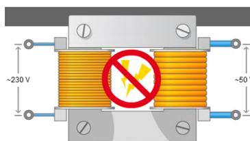
Abbildung 17: Sicherheitstransformator [6]
