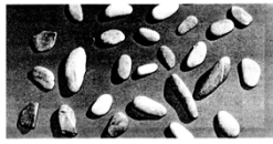
Rundkies mit ungünstigen länglichen und plattigen Kornformen
