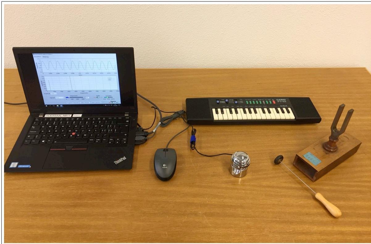
Abbildung 1: Versuchsaufbau „Spectrum-Analyser“
