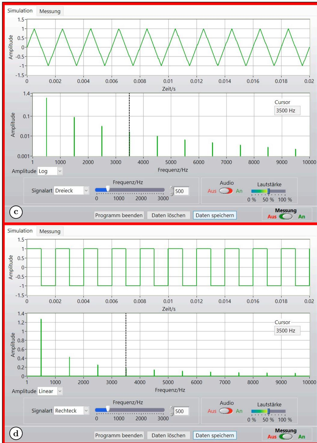
Abbildung 3: Fourierspektren verschiedener Zeitverteilungen: c) Dreiecksverteilung (Amplitude logarithmisch), d) Rechteckverteilung
