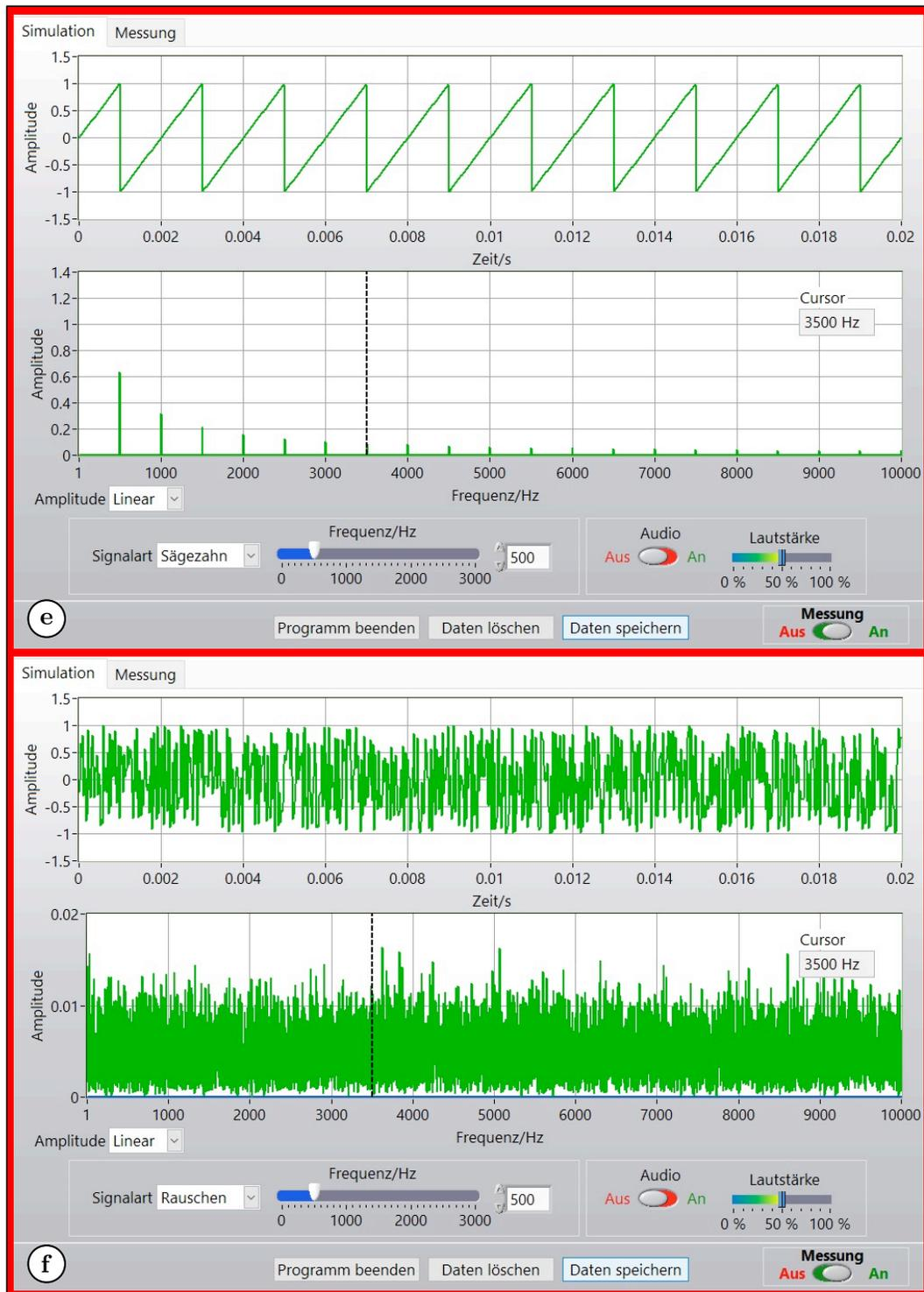
Abbildung 4: Fourierspektren verschiedener Zeitverteilungen: e) Sägezahnverteilung, f) Rauschen
