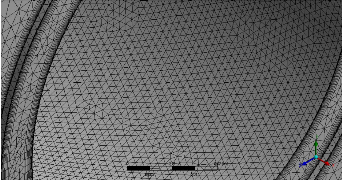
Bild 4-5: Inflation Layer zur besseren Auflösung der Grenzschicht
