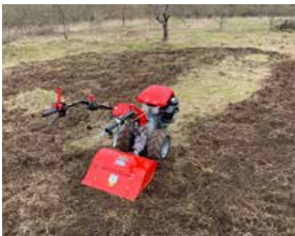
Bodenvorbereitung mit Bodenfräse,
