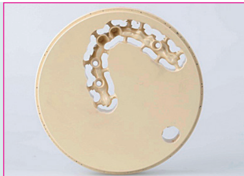
Abb. 12: Fräsung der Bio-HPP Gerüstkonstruktion.
