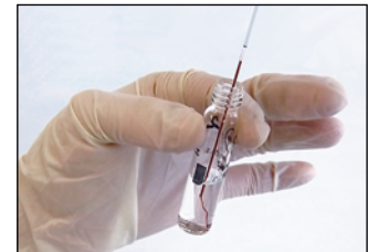
Abb. 5: Blut in Küvette hineinspülen
