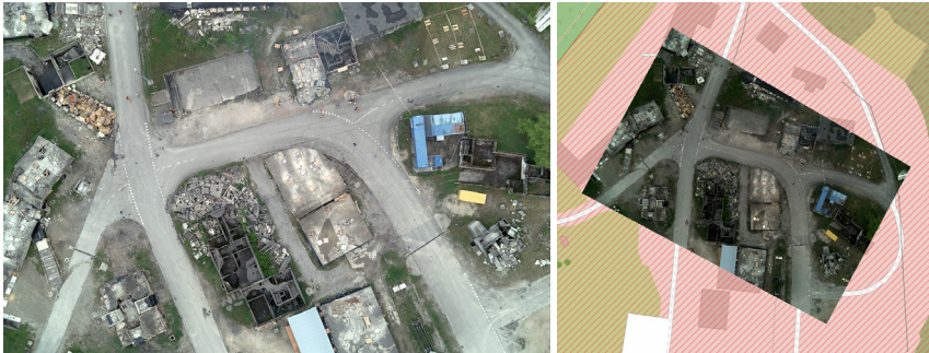
Abb. 4: Luftbildaufnahme (links) und perspektivische Abbildung (rechts) des Luftbildes auf ein geographisches Koordinatensystem (Karte)
