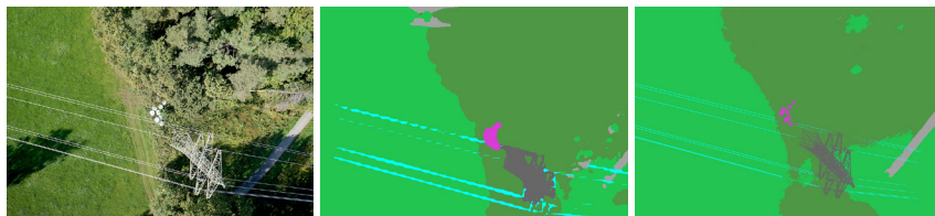
Abb. 6: Semantische Segmentierung eines Testbildes aus Datensatz_1: Links ist das Eingabebild, in der Mitte ein grobes Zwischenergebnis des FCN und rechts die pixelakkurate Segmentierung mittels CRFasRNN dargestellt.
