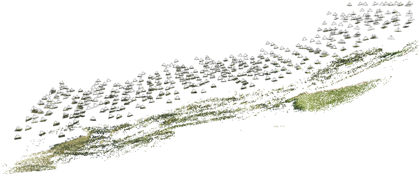
Abb. 8: Sparses Rekonstruktionsergebnis von Datensatz_2. Es zeigt die sparse Punktwolke und Kameraposen, welche mittels Structure-from-Motion berechnet wurden.
