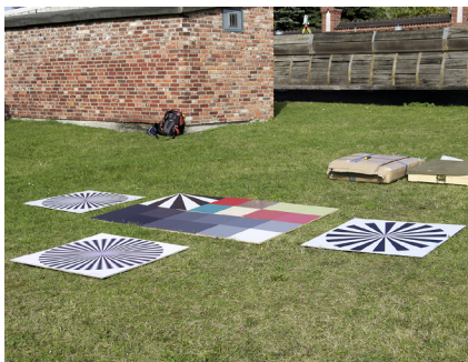
Abb. 3: Anordnung von Siemenssternen und Farbtafeln
