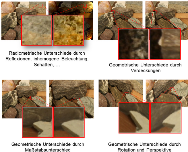
Abb. 4: Radiometrische und geometrische Unterschiede korrespondierender Bildausschnitte
