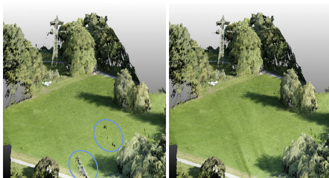
Abb. 15: Vergleich der dichten 3D-Rekonstruktion ohne (Links) und mit (Rechts) Filterung der linienartigen Stromleitungen
