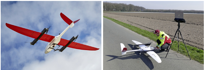
Abb. 2: Unbemanntes Fluggerät mit integriertem Luftbildkamarasystem
