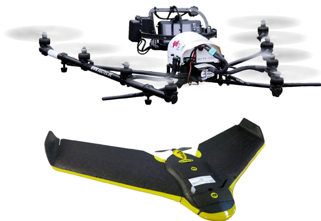
Abb. 3: Aufnahmeplattformen: Die obere Aufnahmeplattform ist ein Falcon 8 von Ascending Technologies GmbH und die untere eine eBee von SenseFly.
