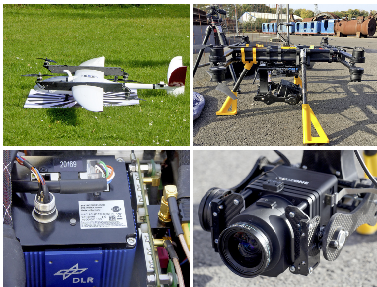
Abb. 8: Oben: Germandrones Songbird (links) und Coptersystems Multicopter (rechts). Unten: MACS SaR (links) und PhaseOne IXU1000 (rechts)
