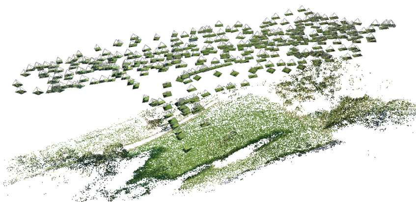
Abb. 7: Sparses Rekonstruktionsergebnis von Datensatz_1. Es zeigt die sparsen Punktwolke und Kameraposen, welche mittels Structure-from-Motion berechnet wurden.
