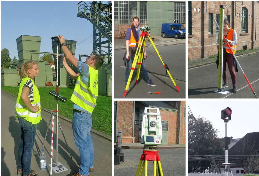
Abb. 5: GNSS-RTK-System LEICA GS16 (links), Präzisionsnivellier LEICA DNA03 und kodierte 2-m-Invarbandlatten (oben Mitte und oben rechts), LEICA TS15 mit Miniprima GMP111-0 und LEICA-Rundprisma (unten Mitte und unten rechts)
