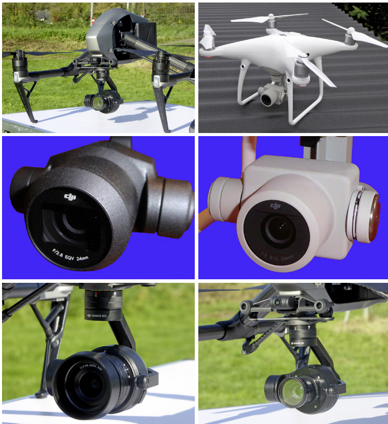
Abb. 9: Oben: DJI Inspire 2 (links) und DJI Phantom4 Pro (rechts). Mitte: Zenmuse X4S für Inspire 2 (links) und Phantom4 Pro (rechts). Unten: Zenmuse X5S (links) und die von DLR OS umgebaute Kamera (rechts)
