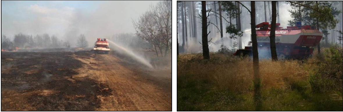
Abb. 48-49. Einsatz von Löschpanzer des Typs SPOT-55 bei der Absicherung von Kontrollierten Feuern im Naturschutzgebiet Heidehof-Golmberg und bei der Bekämpfung eines Feuers in einer munitionsbelasteten Waldfläche.
