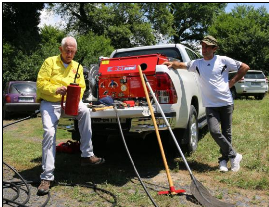
Abb. 36 und 37. Beispiel des Aufbaus einer leichten, geländegängigen und leistungsfähigen Feuerlöschereinheit auf einem Standard-Fahrzeug der Forstverwaltung und Landschaftspflegeverband in Khaketi, Georgien (Süd-Kaukasus) durch GIZ und GFMC (2018). Mit Hochdruckpumpen und Schläuchen kleinen Durchmessers können mit minimalem Wasserverbrauch die von landwirtschaftlichen Flächen auf Wälder und Schutzgebiete übergreifenden Feuer effektiv und vor allem effizient gelöscht oder mit kontrollierten Gegenfeuern kontrolliert werden. Hier sind solche Einheiten denen der traditionellen Feuerwehren und deren schweren Ausrüstungen „nach Vorschrift“ weit überlegen.
