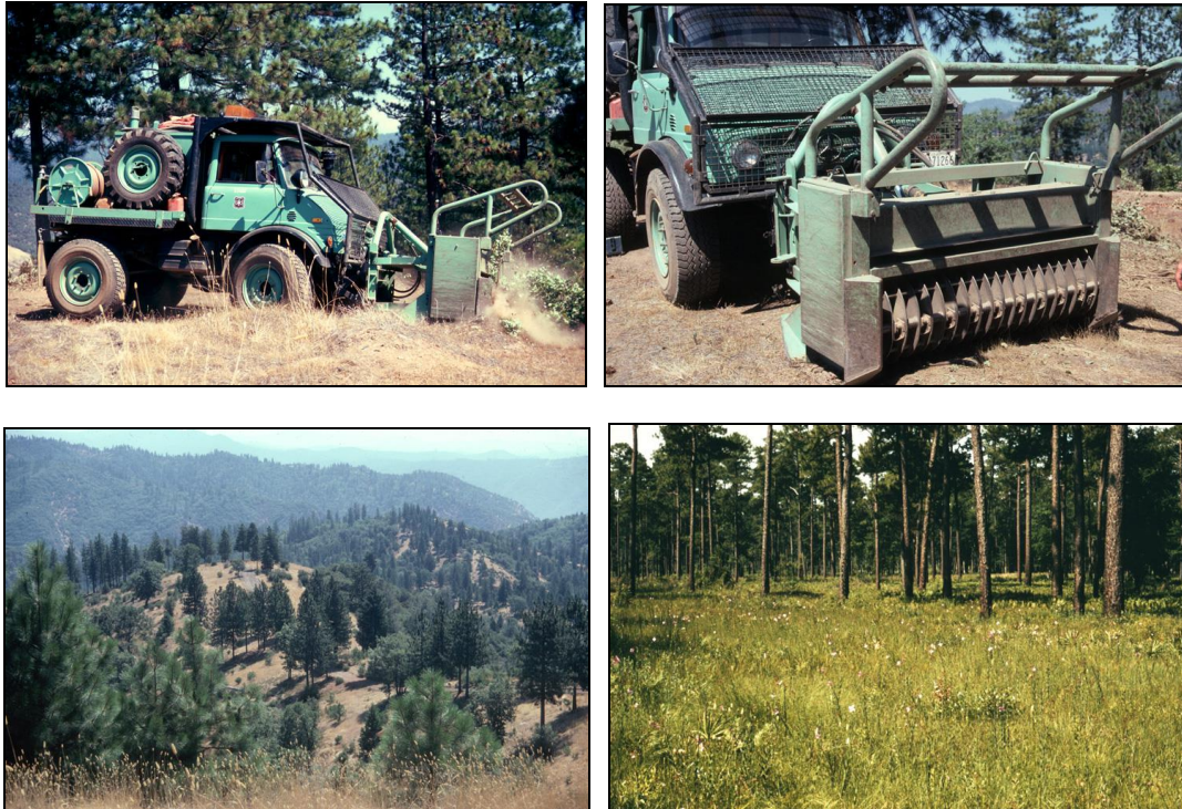
Abb. 30 - 33. Bis in die 1990er Jahre verwendete der U.S. Forest Service Unimogs mit Schlegelmulchgeräten, um offene Waldbrandriegel an strategischen Positionen anzulegen, beispielsweise auf Bergkuppen wie hier in Kalifornien. Das geschredderte Brennmaterial bildet eine kompakte Auflage, in der Feuer sich nur sehr langsam ausbreitet und in den offenen, parkartigen Beständen leicht bekämpft werden kann. Gleichzeitig dient die kompakte Auflage als Erosionsschutz. Auf anderen Standorten, wie beispielsweise im Südosten der USA (Florida, Georgia) bildet sich artenreiche, naturschutzfachlich wertvolle Bodenvegetation, beispielsweise ein Lebensraum für gefährdete Orchideenarten.
