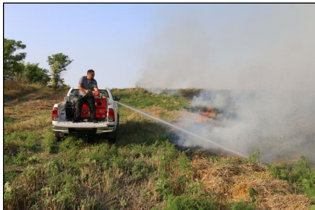
Abb. 36 und 37. Beispiel des Aufbaus einer leichten, geländegängigen und leistungsfähigen Feuerlöschereinheit auf einem Standard-Fahrzeug der Forstverwaltung und Landschaftspflegeverband in Khaketi, Georgien (Süd-Kaukasus) durch GIZ und GFMC (2018). Mit Hochdruckpumpen und Schläuchen kleinen Durchmessers können mit minimalem Wasserverbrauch die von landwirtschaftlichen Flächen auf Wälder und Schutzgebiete übergreifenden Feuer effektiv und vor allem effizient gelöscht oder mit kontrollierten Gegenfeuern kontrolliert werden. Hier sind solche Einheiten denen der traditionellen Feuerwehren und deren schweren Ausrüstungen „nach Vorschrift“ weit überlegen.
