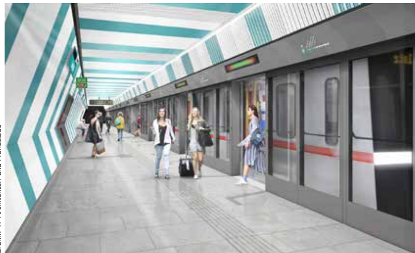
Durch die Bahnsteigtüren sollten größere Hindernisse auf der Strecke nicht auftreten, der Zug erkennt diese jedoch jedenfalls selbstständig und bremst rechtzeitig ab
