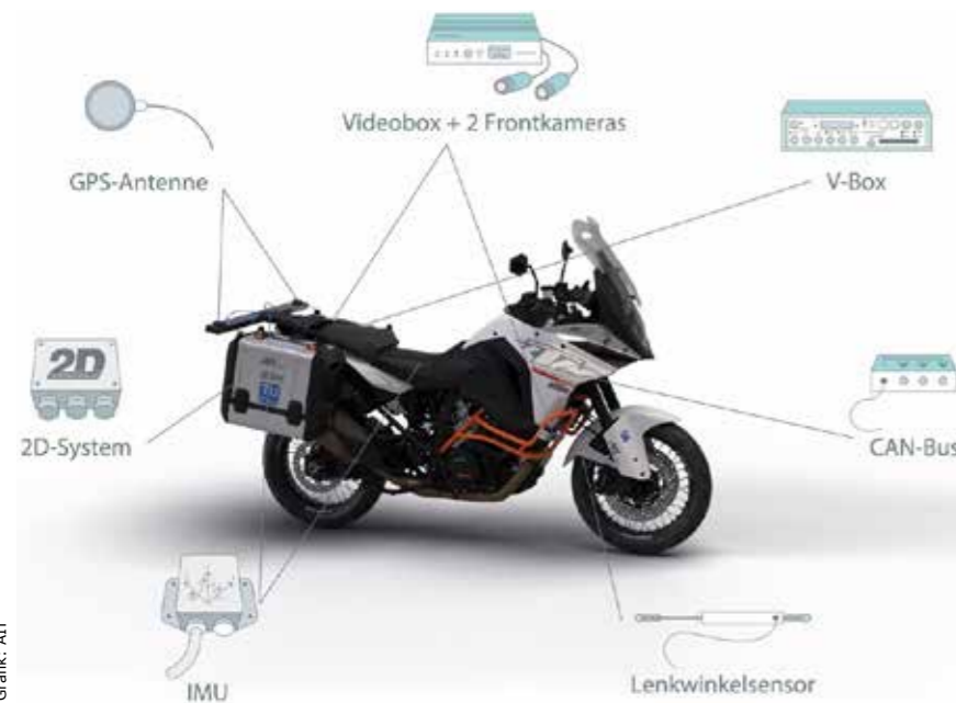
Bestandteile des intelligenten Messmotorrads
