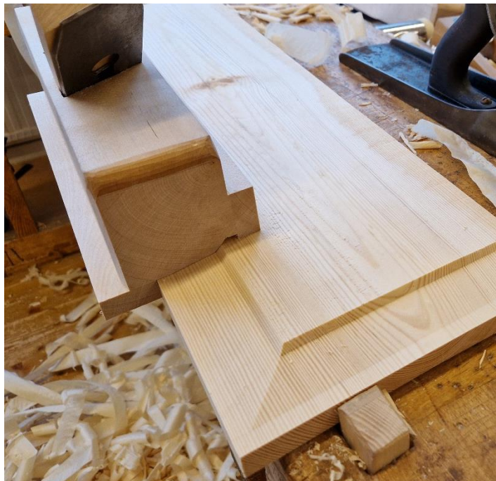
Figur 37. Frishyveln och en provbit. Fyllningen beskriven från vänster: fjädern, flacka delen, branta delen samt spegeln.
