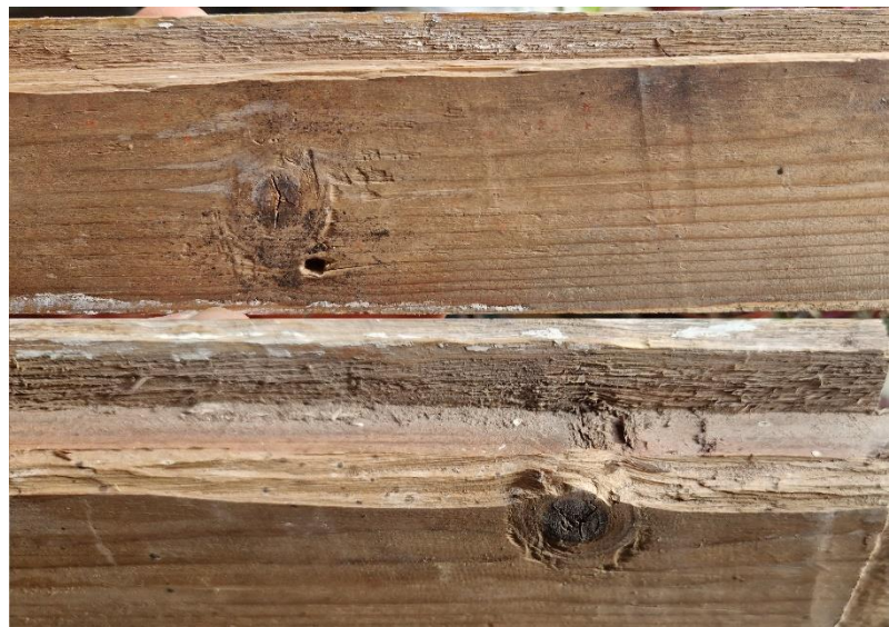
Figur 22. Två bilder av baksidan av mellanstycket som visar brottytan efter andra halvan av notspåret, och spår efter hyvling.
