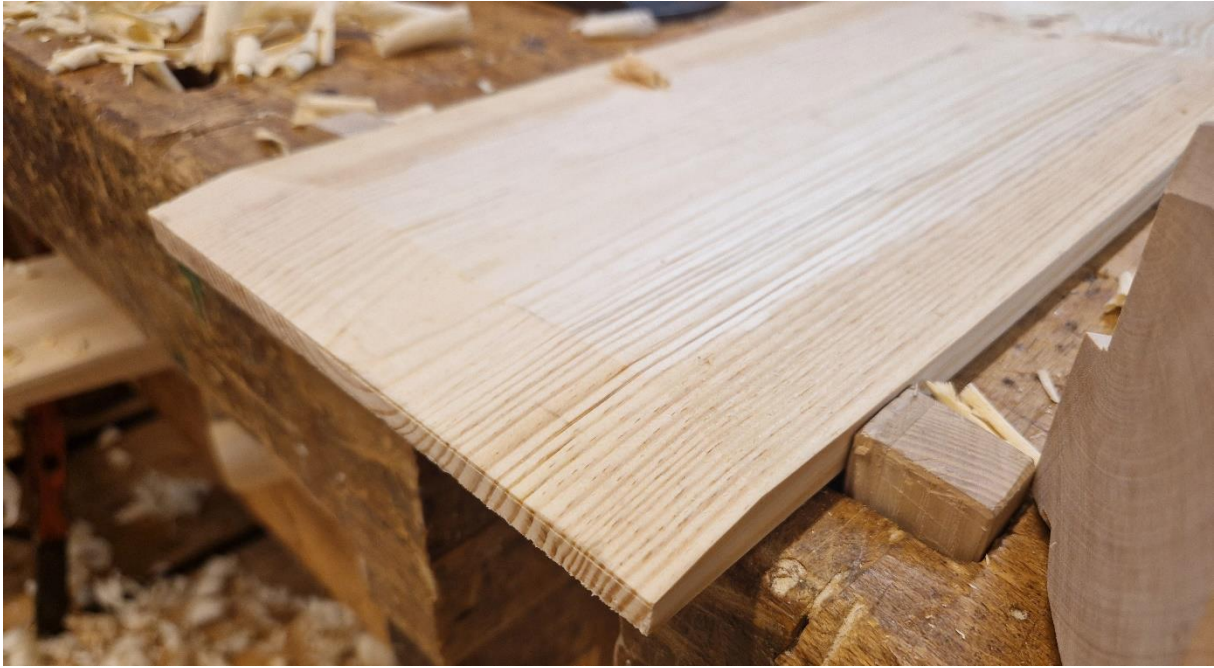
Figur 38. Fyllningen efter grovavverkning med en grovsläthyvel. I nästa steg används frishyveln.
