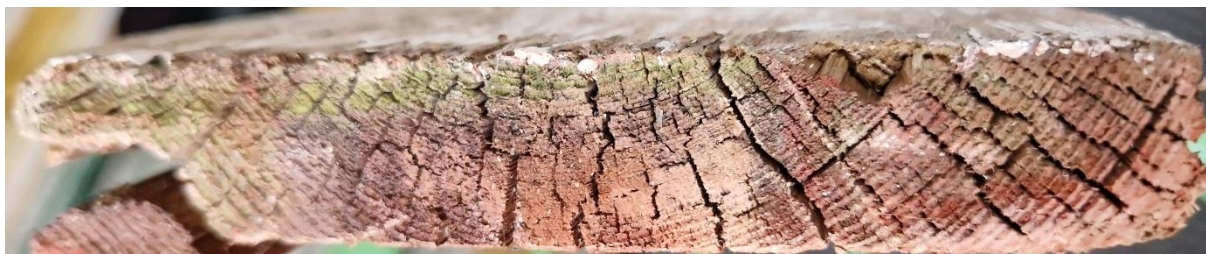
Figur 23. Bild av högra sidostyckets nedre ända med jämna och smala årsringar.
