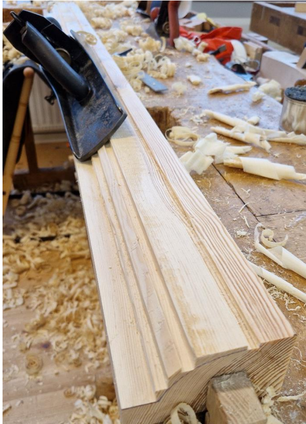
Figur 31. Grovavverkning med en Stanley nr. 6.
