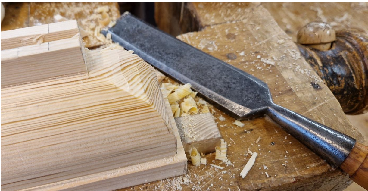
Figur 36. Det sista skars rent vågrätt för att lättare kunna se.
