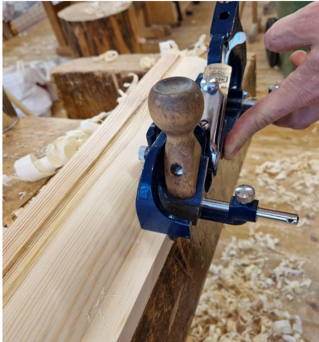
Figur 33. En falshyvel används för att snygga till plattan efter hyvlandet av rundningen.
