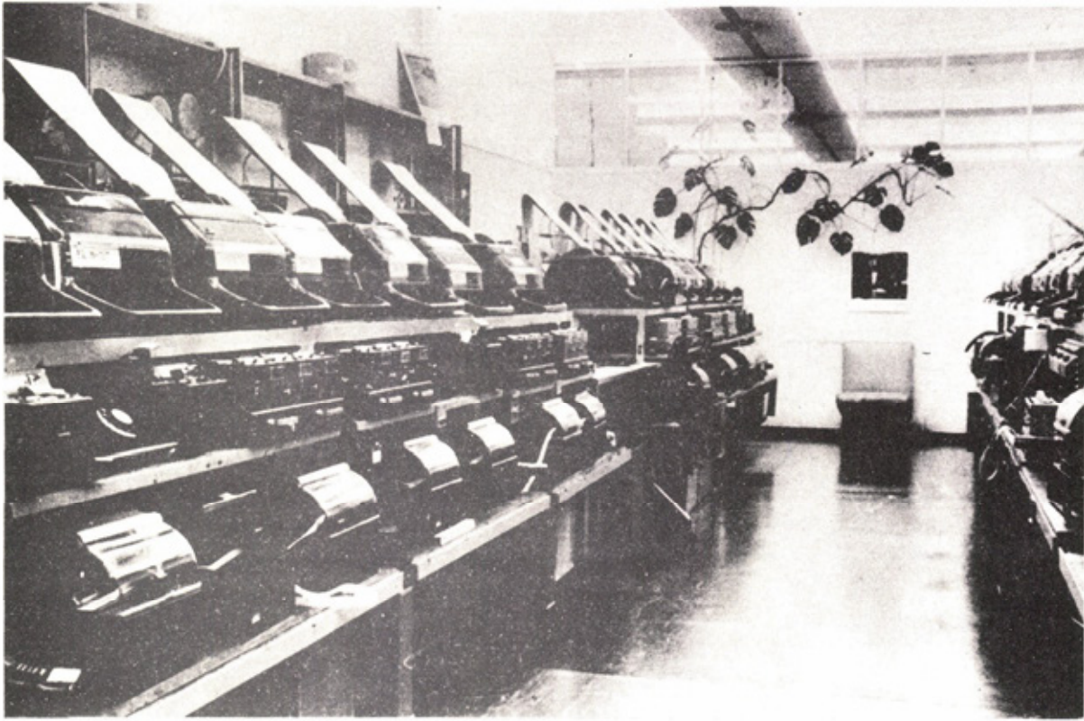
Bild 3: SWISSAIR Comcenter, Kloten Speichervermittlung mit geschnittenem Lochstreifen, 11 ankommende, 11 ab- gehende Leitungen
