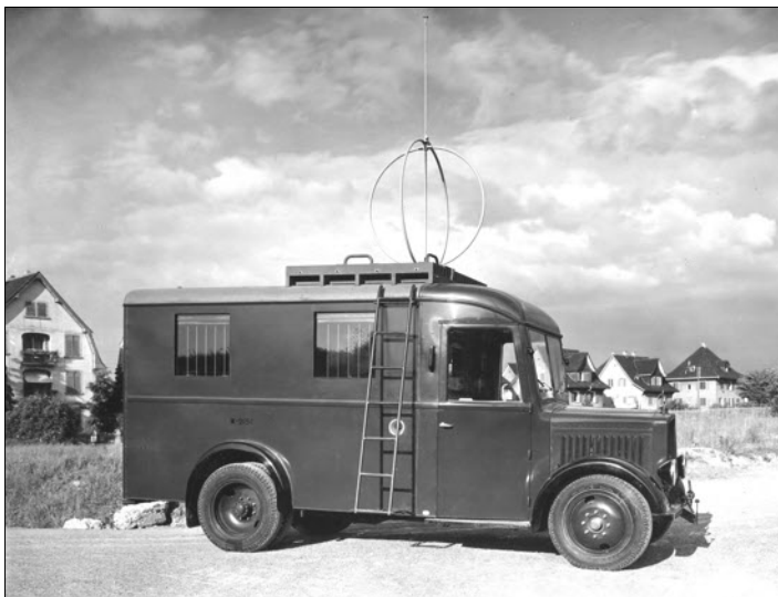
Bild 8: BERNA-Lastwagen mit Peilanlage P-708/m.
