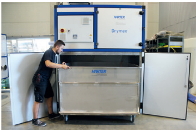
Der mit Schlamm befüllte Container wird in den Trockner eingefahren und bei ca. 50 °C 24 Stunden lang auf die gewünschte Restfeuchte getrocknet.
