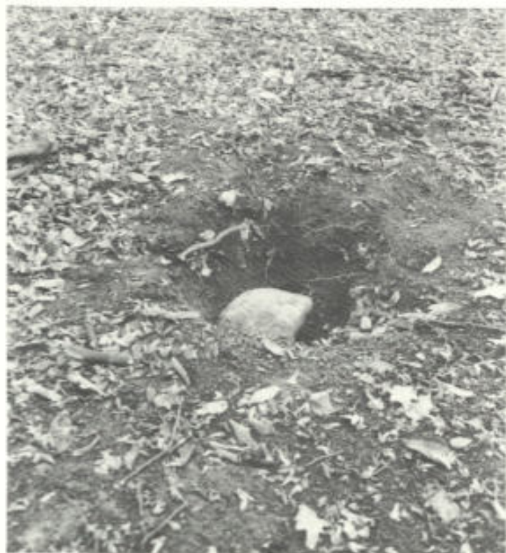
Abb. 1. Grenzsteine der Urmessung in der Gemarkung Oppum Flur 4 in ihrer unterirdischen Sicherung
