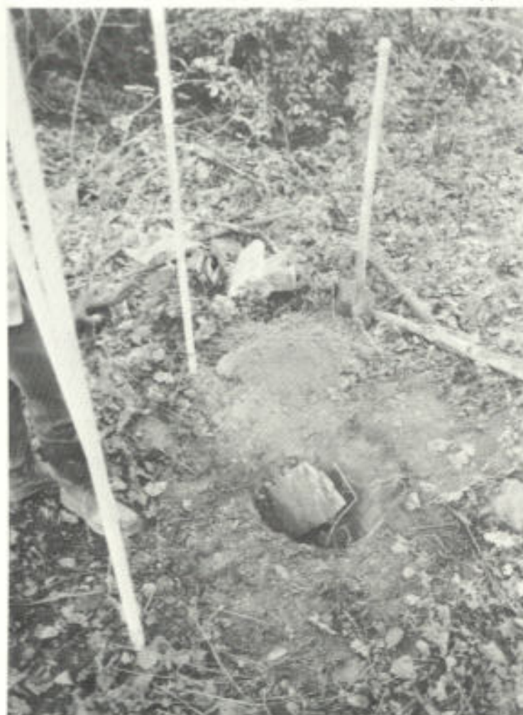
Abb. 1. Grenzsteine der Urmessung in der Gemarkung Oppum Flur 4 in ihrer unterirdischen Sicherung
