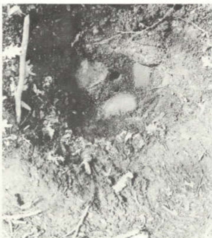
Abb. 1. Grenzsteine der Urmessung in der Gemarkung Oppum Flur 4 in ihrer unterirdischen Sicherung
