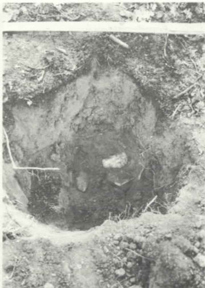
Abb. 1. Grenzsteine der Urmessung in der Gemarkung Oppum Flur 4 in ihrer unterirdischen Sicherung
