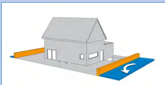
Abb. 7 – Abschirmung des Gebäudes
