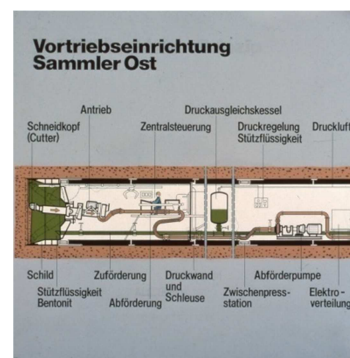
Abb. 6: Detaillierter Aufbau am Maschinenkopf
