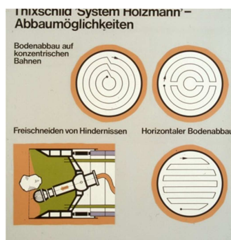
Abb. 11: schematische Darstellung programmierbarer Abbaubahnen
