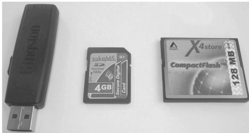
Figure 11.8: Verschiedene Flash-Speicher; Links: Ein USB-Memory-Stick; Mitte: eine Secure-Digital-Card; Rechts: eine CompactFlash-Card
