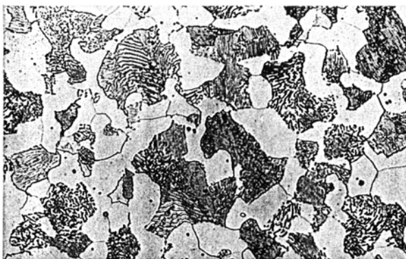
Bild 26. Umwandlung in der Perlitstufe
