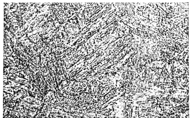
Bild 27. Umwandlung in der Zwischenstufe
