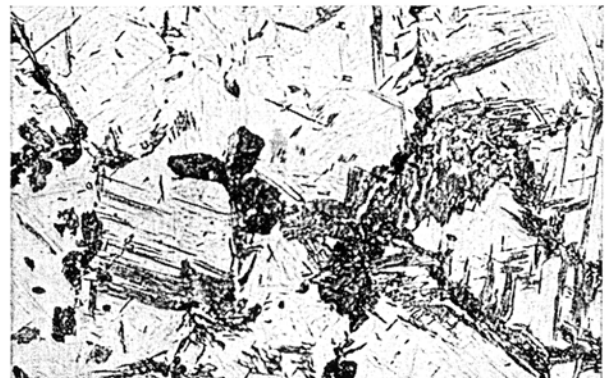
Bild 29. Umwandlung bei kontinuierlicher Abkühlung im Bereich der kritischen Abkühlgeschwindigkeit
