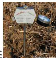
Kontrolle der Bodenfeuchte mit einem Tensiometer
