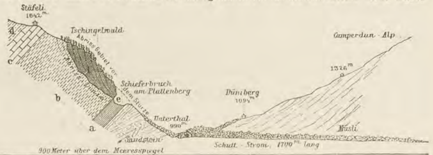
Fig. 183. Profil durch das Gebiet des Bergsturzes bei Elm vom 11. September 1881 nach A. Heim. a eocäne Dachschiefer, b weichere Schiefer, c Nummulitenkalk, d Schiefer, e ehemaliger Schieferbruch, f abgestürzte Schiefermasse.
