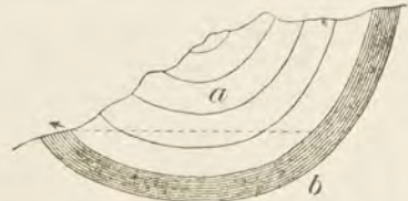
Fig. 177. Überfallquelle. a durchlässig, b undurchlässig.
