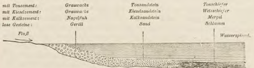
Fig. 170. Schematische Darstellung der Bildung der Trümmergesteine.
