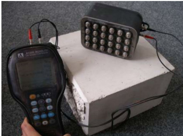
Bild 4: Ultraschall-Handgerät (links) und Messkopf mit 24 Punktkontakt-Prüfköpfen
