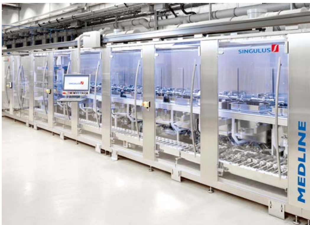
MEDLINE Reinigungs- und Beschichtungsanlage für medizinische Artikel wie z. B. Tageslinsen und Herzschrittmacher.
