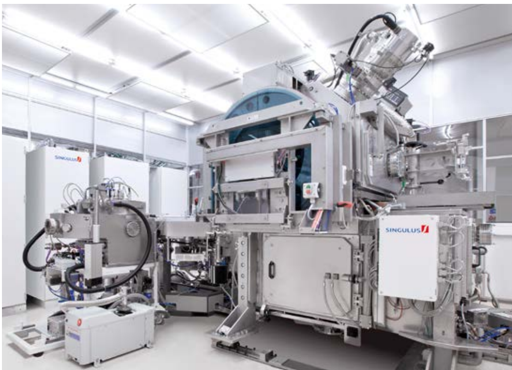
TIMARIS Ultra-Hochvakuum- Beschichtungsanlage für die Halbleitertechnik.
