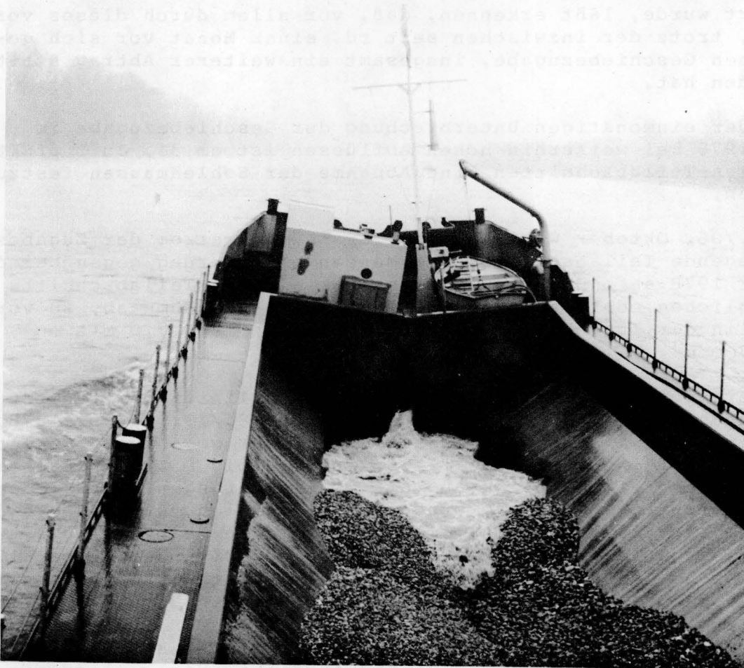
Bild 16 Blick in eine Klappschute kurz vor Abschluß des Verklappens
