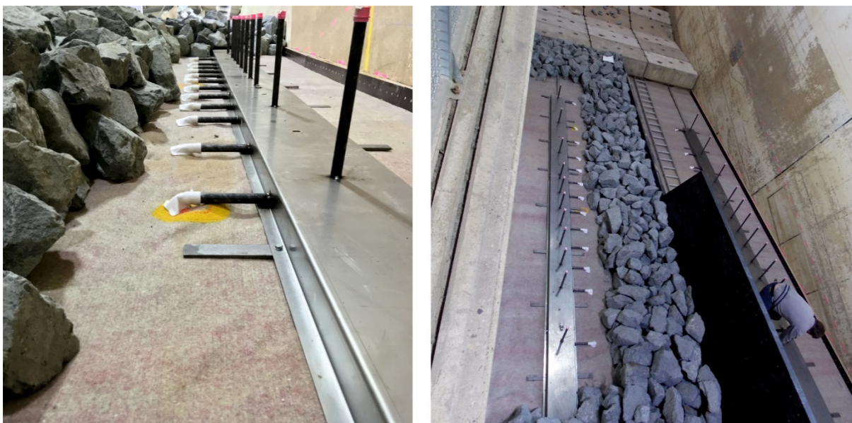
Abbildung 13: Druckmessdosenkanal in der Deckschicht (Fotos: Kreyenschulte 2017).
