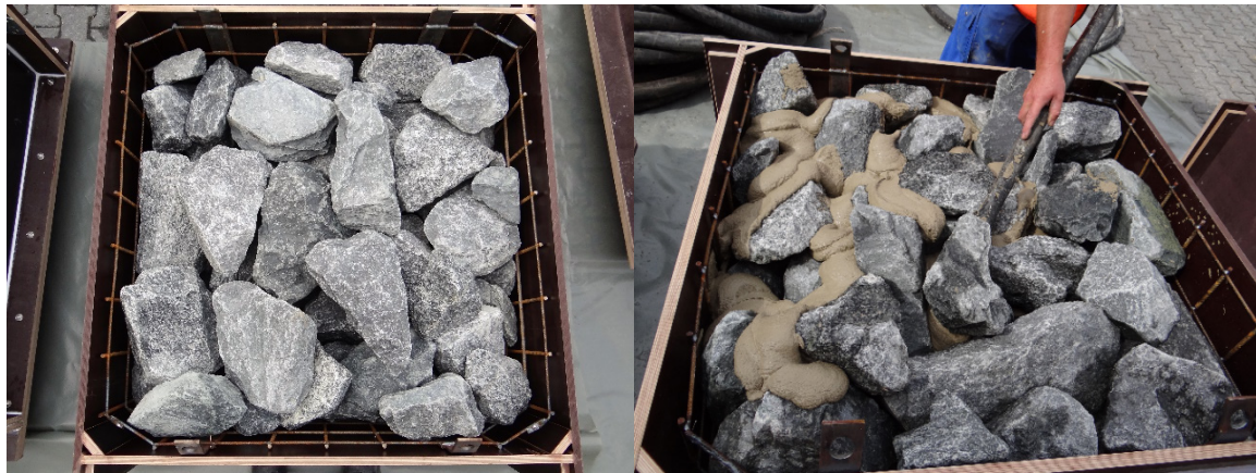
Abbildung 16: Unvergossener Versuchskörper in der Draufsicht in der Schalung (links) und Verguss eines Versuchskörpers von Hand (rechts) (Fotos: Kreyenschulte 2016).
