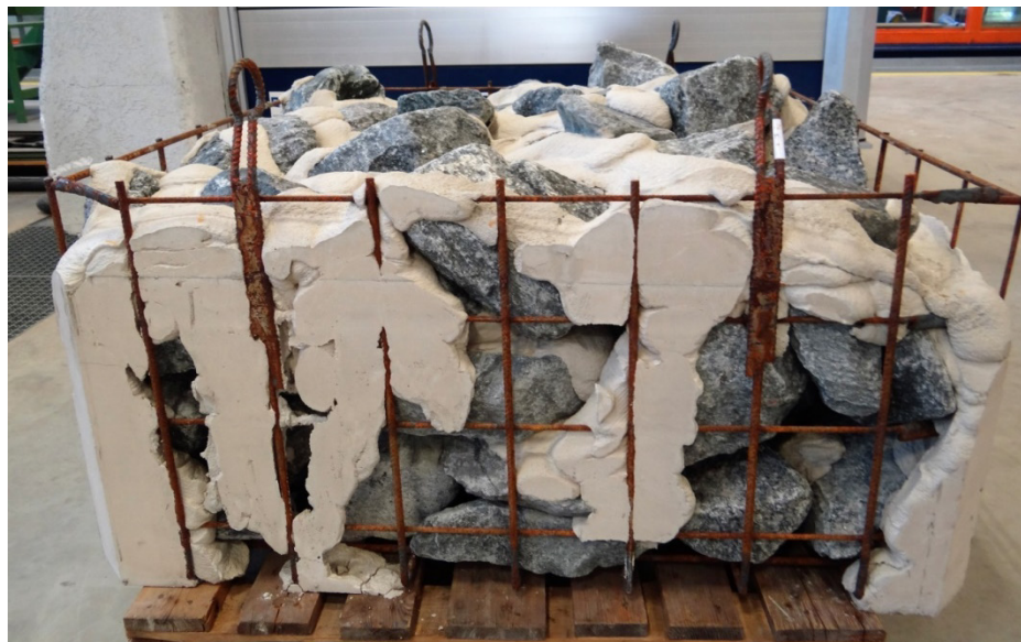
Abbildung 18: Vergossener Versuchskörper, d = 60 cm, Vergussmenge q_v = 100 l/m 2 (Foto: Kreyenschulte 2016).
