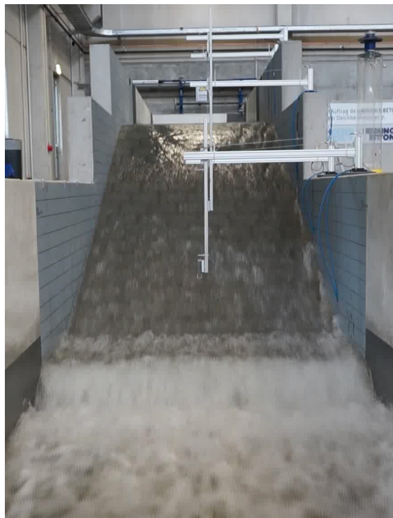
Abbildung 20: Modelldeich während Überströmversuch.
