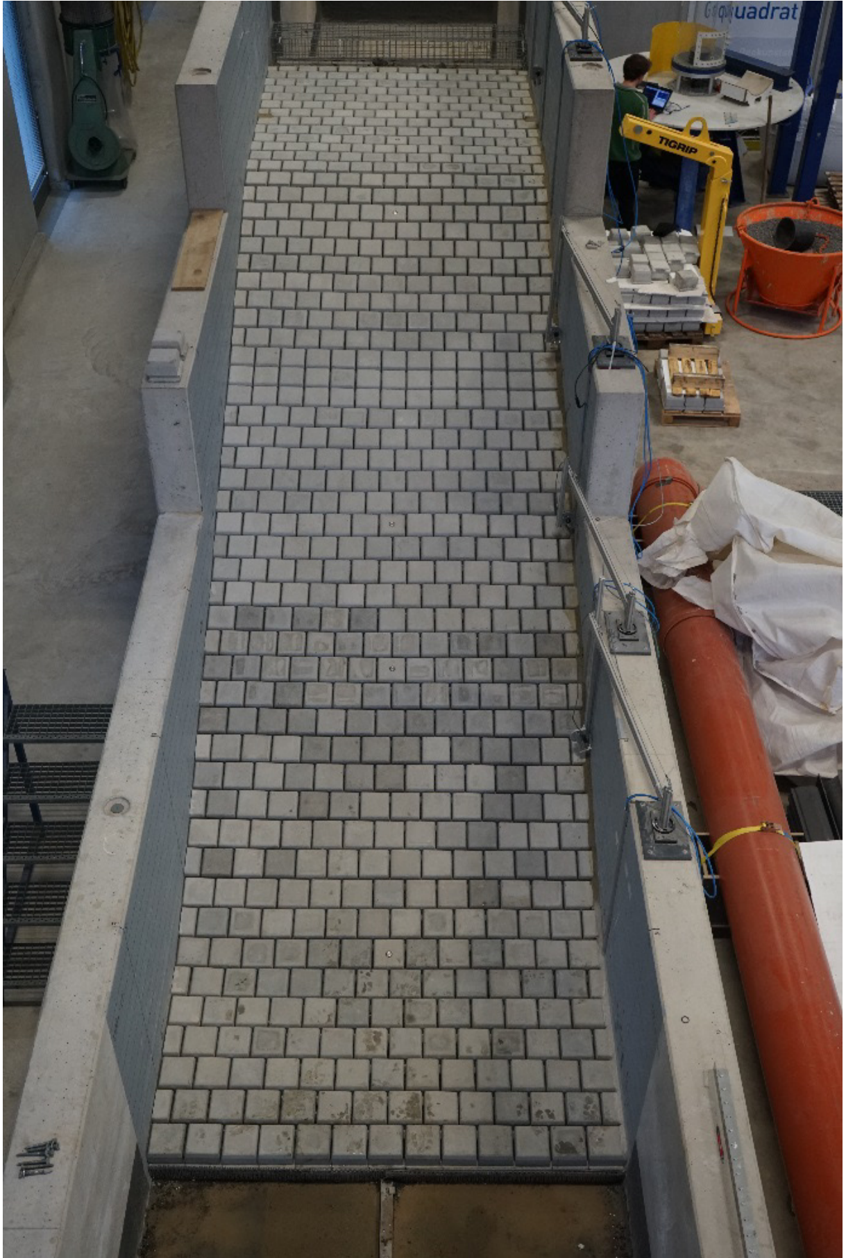
Abbildung 15: Der aufgebaute Modelldeich in der Draufsicht (Messtechnik eingeklappt).
