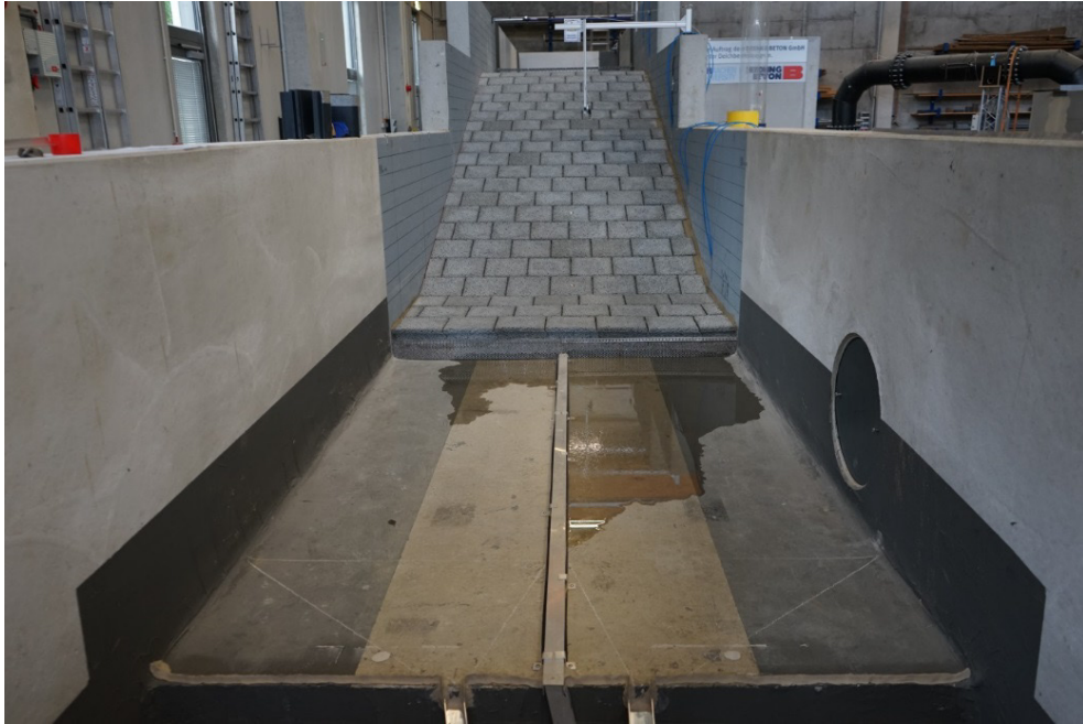
Abbildung 19: Erster Sickerwasseraustritt am Deichfuß.
