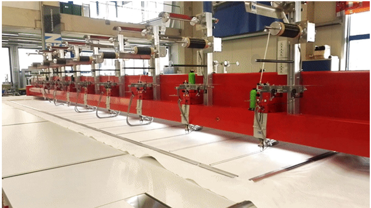
Abbildung 4: Aufsticken der Sensoren (Carbonfasern) auf Wasserbauvlies unter Einsatz einer achtköpfigen Stickmaschine (Foto: Schwab 2018).
