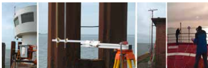
Abb. 11: v.l.n.r. Messstangen am Pegel Dagebüll, Messbänder am Pegel Borkum-Fischerbalje und klassische Nivellements auf Mellumplate
