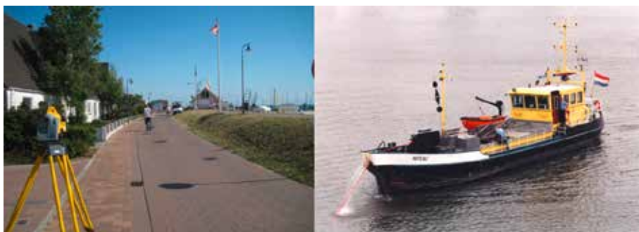
Abb. 3: Geometrisches und hydrostatisches Nivellement
