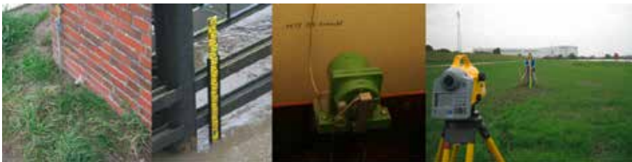
Abb. 2: Pegelfestpunkt, Lattenpegel, Wasserstandssensor und Anschlussmessung an einem Pegel
