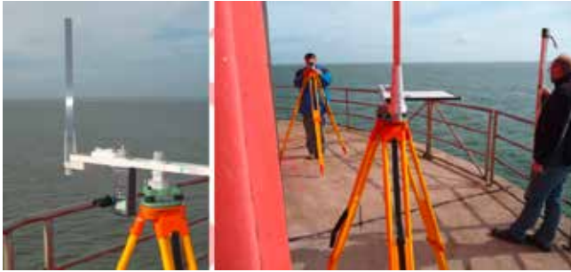
Abb. 12: Messungen mit einem vertikal arbeitenden Laserentfernungsmesser (Pegel Mellumplate)
