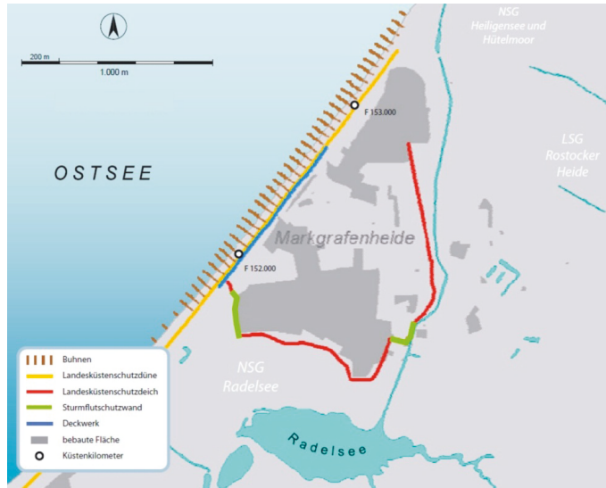
Abbildung 3: Sturmflutschutzmaßnahmen für die Ortschaft Markgrafenheide (Quelle: Regelwerk Küstenschutz Mecklenburg-Vorpommern).
