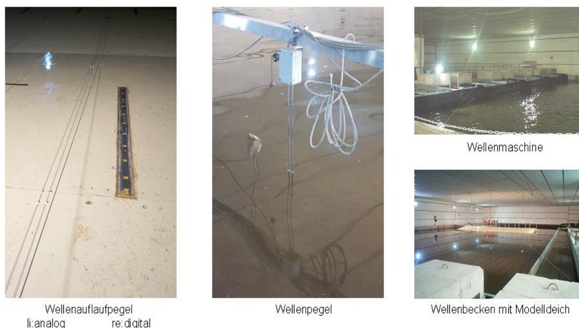
Abb. 12: Messgeräte in der zweiten Versuchsphase und Wellenmaschine sowie der Modelldeich
