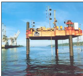
Bild 3: Drucksondierungen auf dem Wasser
