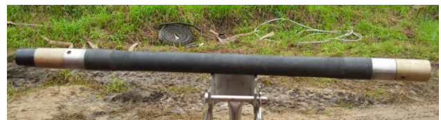
Bild 13: Pressiometer auf der Baustelle
