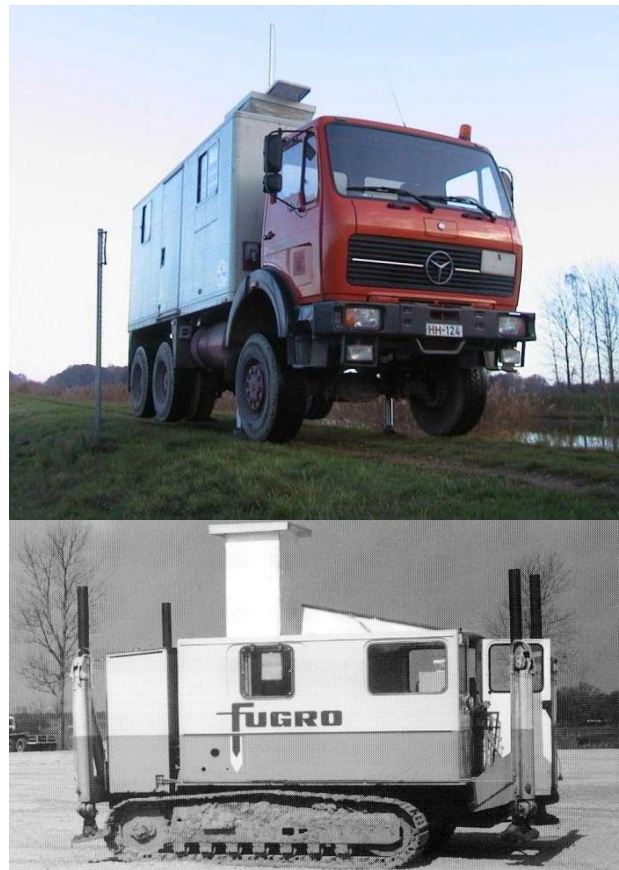
Bild 2: Sondiergeräte für Drucksondierungen an Land
