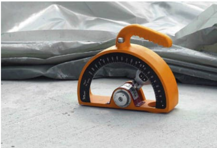
Abbildung 4: Zerstörungsfreie Prüfung der Betondruckfestigkeit mit dem Pendelhammer [1]
