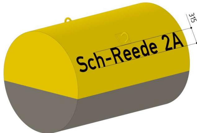
Abbildung 98: Reedetonne mit abgekürztem Namen und Nummerierung
